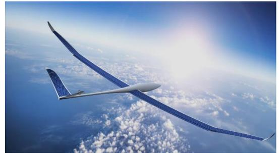
Quant aux **plateformes de haute altitude** (High Altitude Platform System – HAPS), ce sont des aéronefs, généralement des avions, des dirigeables ou des ballons, positionnés entre 18 et 30 km d'altitude pour composer un réseau de télécommunications ou de télédétection dans le cadre d'applications civiles et militaires.
